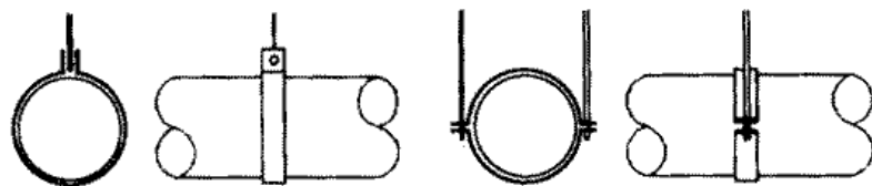
图 4.2.14 柔性风管吊卡箍安装
